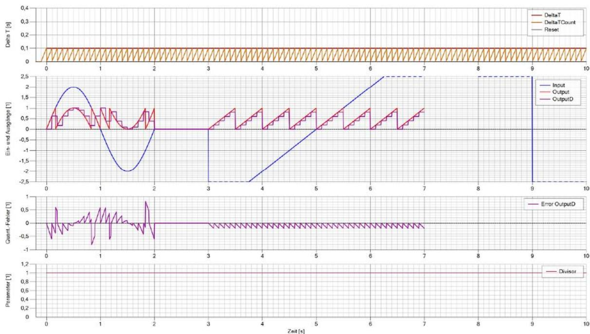
Abb. 3-46: Funktionsblock-Testergebnis: Modulo2
