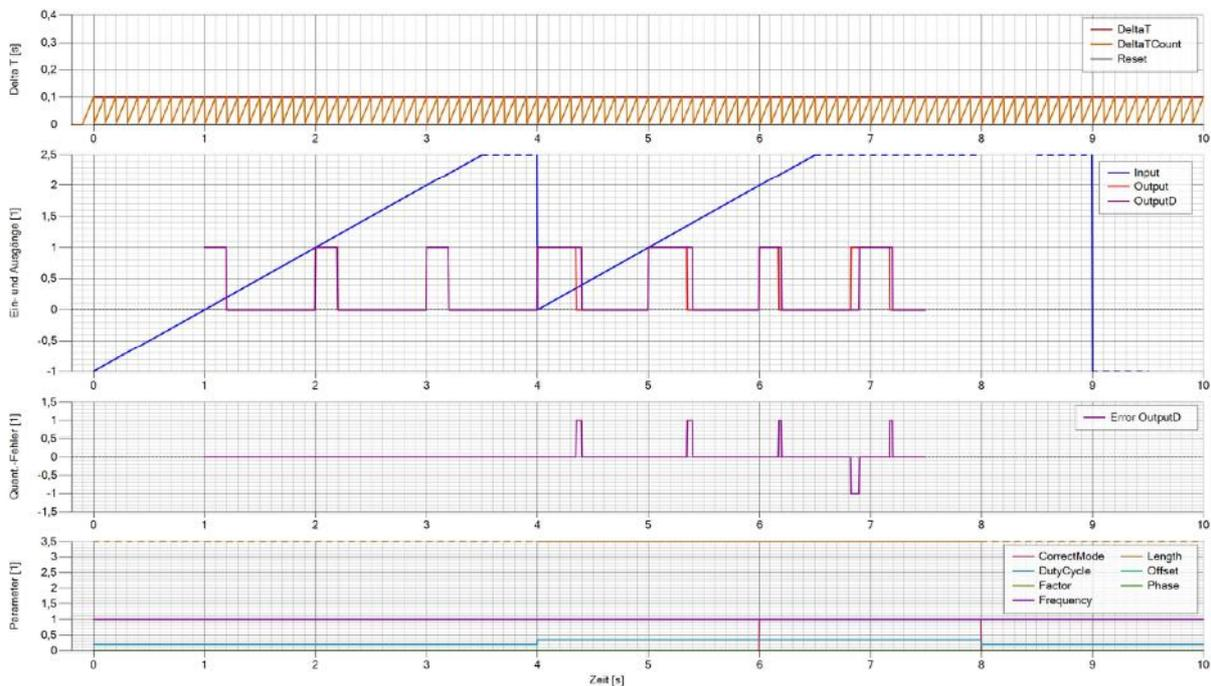
Abb. 3-59: Funktionsblock-Testergebnis: PWM-Funktion
